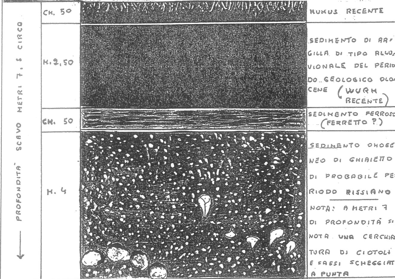
DURANTE UNO SCAVO PER LA POSA DI UN COLLETTORE DELLA PROFONDITÀ DI CIRCA 7,8 M; SI È EVIDENZIATA UNA STRATIFICAZIONE GEOLOGICA MOLTO INTERESSANTE. SUL FONDO SI È NOTATO UNA CERCHIATURA DI CIOTOLI ANDATA PERDUTA DURANTE I LAVORI E DEI SASSI SCHEGGIATI A PUNTA DEL TIPO CHOPPER O CHOPPING TOOL DA ME RECUPERATI. (FOTO A DESTRA)
