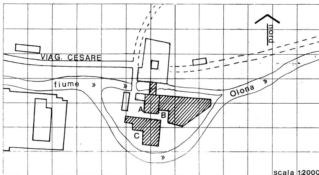
*Descrizione:* (A) corpo di fabbrica a pianta rettangolare a 2 piani con struttura in mattoni e pietra. Solai in legno, copertura con struttura in legno a varie falde con tegole.
