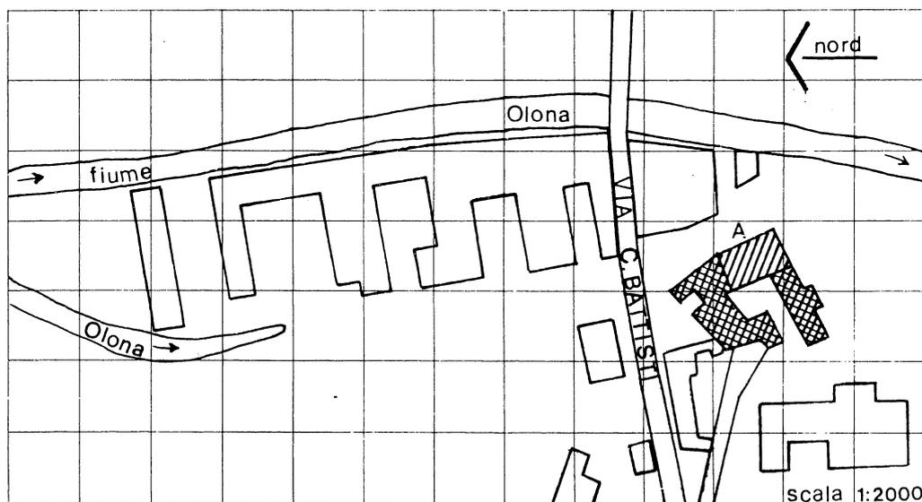
*Descrizione:* Edificio a pianta irregolare a 2 piani; una parte è stata ristrutturata. La parte rimasta inalterata (A) ha la struttura in mattoni e pietra, solai in legno, copertura con struttura in legno con coppi.
