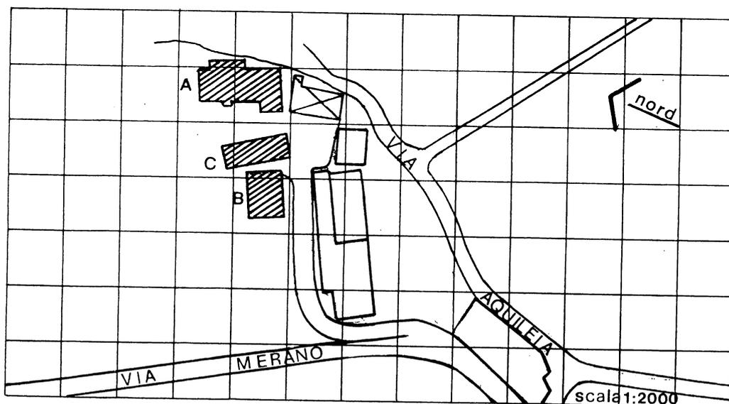
*Descrizione:* Tre corpi di fabbrica a pianta rettangolare: (A) edificio a 3 piani con struttura in mattoni; solai in ferro e laterizio; copertura con struttura in legno a 2 falde in marsigliesi. (B) edificio a 3 piani con struttura in mattoni; solai in ferro e laterizio; copertura con struttura in legno a 4 falde in marsigliesi. (C) edificio a 2 piani con struttura in mattoni; solai in ferro e laterizio; copertura con struttura in legno a 4 falde in marsigliesi.
