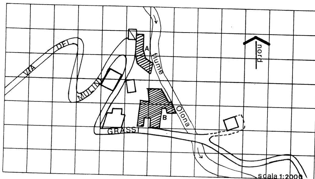
*Descrizione:* (A) corpo di fabbrica a pianta irregolare con il lato a monte a due piani, quello a valle a quattro piani. Struttura in pietra, solai in legno, copertura con struttura in legno e coppi a piú falde. (B) corpo di fabbrica a pianta irregolare a tre piani con struttura in pietra e mattoni, solai in legno e copertura con struttura in legno e coppi a piú falde.
