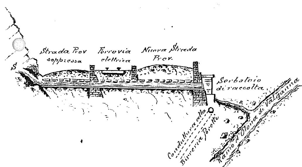
strada Provinciale abbandonata, quindi la sede della ferrovia elettrica Varese - Luino per la Valganna e finalmente il nuovo tronco di strada Provinciale per metter capo a un serbatoio si racconta addossato al muro di sostegno di detta strada.
